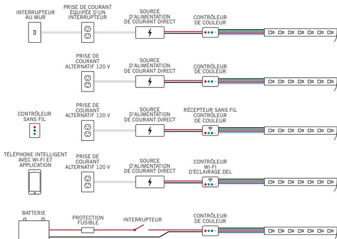
Les éclairages installés sur des véhicules récréatifs et des bateaux peuvent être alimentés directement avec une batterie. Assurez-vous que l'éclairage du ruban DEL que vous utilisez correspond à la tension de votre véhicule récréatif ou bateau.
