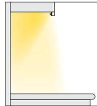
Une installation continue de la bande d'éclairage DEL est obtenue en perçant un trou de 1 ¼ cm (½ po) à travers les rebords latéraux du cadre de l'armoire. Pour installer sur la face du rebord arrière du cadre, utilisez une scie oscillante polyvalente pour effectuer de petites coupes verticales dans les séparations afin de créer des fentes qui permettront à la bande d'éclairage de passer d'une armoire à l'autre.
